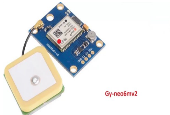
Fig. 7: GY-NEO6MV2 GPS Tracking Module
